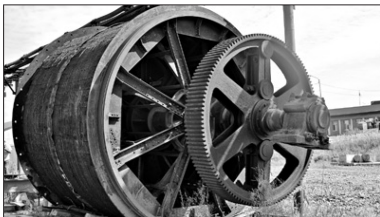
Прежняя подъёмная машина немецкой фирмы Simag была введена в эксплуатацию в 1934 году. Сейчас решается вопрос о её размещении на территории рудоуправления как память о первостроителях рудника и российской калийной отрасли в целом.
